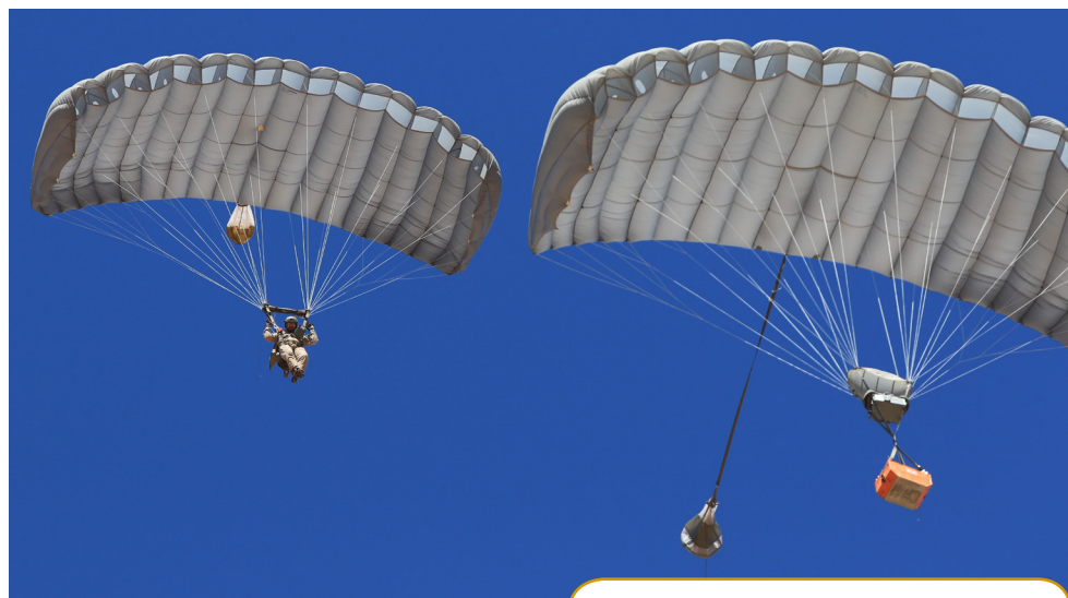
Parachutiste suivant un MicroFly II® pendant un largage combiné, tous les deux sous des voilures de type Intruder® 360
