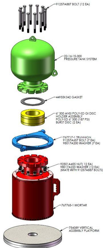
PNEUMATIC PORTION OF 767767-1 PNEUMATIC MORTAR SYSTEM
