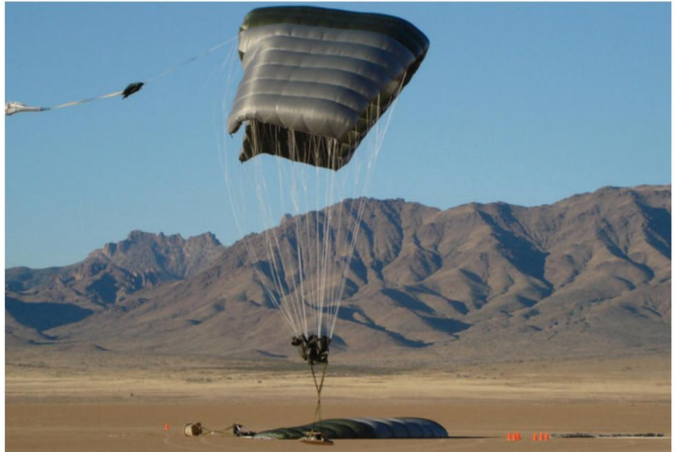
el sistema. Así como un saltador bajo la cúpula lee continuamente los vientos y hace las correcciones necesarias, el FireFly® hace correcciones continuas hasta la desaceleración final para aterrizar.
