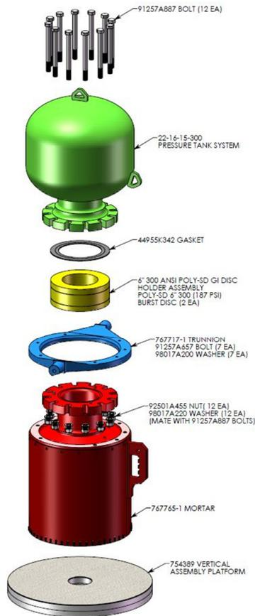
PNEUMATIC PORTION OF 767767-1 PNEUMATIC MORTAR SYSTEM
